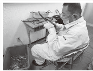
銅線の剥離作業
